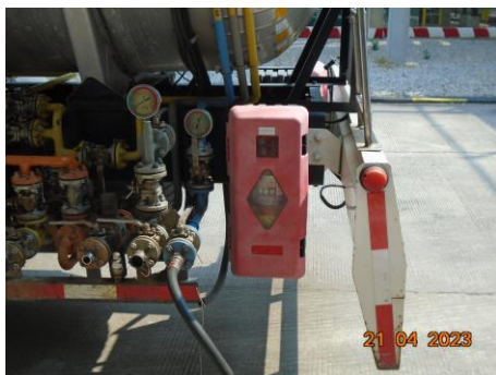
ภาพที่ 2.1-19 อุปกรณ์ความปลอดภัยต่าง ๆ สำหรับขนส่ง ได้แก่ ถังสารเคมีดับเพลิง, SDS และ PPE ประจำรถขนส่ง เป็นต้น
